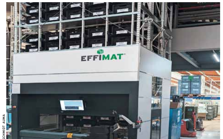
Der „Effimat“ steht völlig frei im Raum. Dieser ist oberhalb einer 3,10 Meter Standardschutzverkleidung offen und die Behälter sichtbar.
